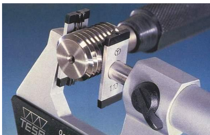
Obr. 3.1 Měření závitu třídrátkovou metodou (zde použity příložné destičky pro mikrometr).
