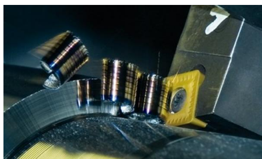
Obr. 2.3 Tvorba třísky při soustružení.
