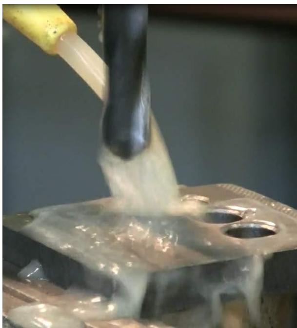
Obr. 3.1 Vrtání. Vrták je vícebřitý nástroj, typicky dvoubřitý. Zpravidla se využívá procesní kapalina.
