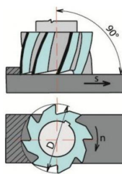
Obr. 6.2 Schéma čelního frézování při \kappa_r = 90^\circ .
