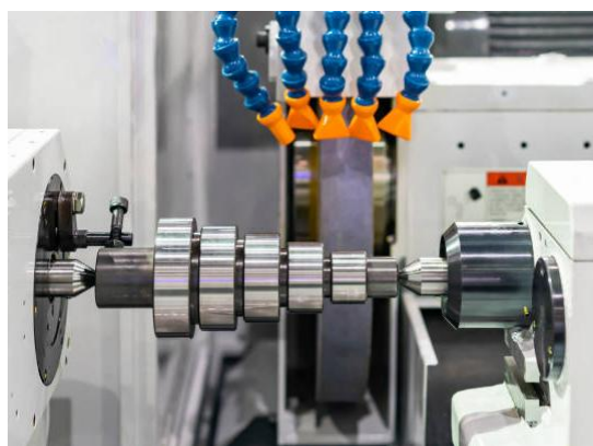
Obr. 1.3 Broušení mezi hroty na kulato.
