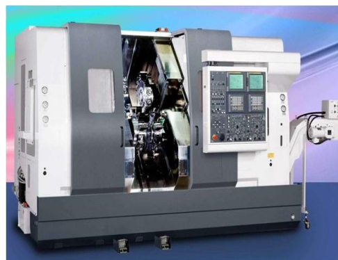
Obr. 2.2 Ukázka CNC obráběcího stroje, který má 2 vřetena a 4 suporty, jejichž zásobníky umožňují používat poháněné nástroje.
