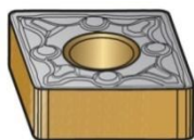
Obr. 2.3 Oboustranná VBD, tvar C, má 2+2 břity (útvařeč lze vynechat).
