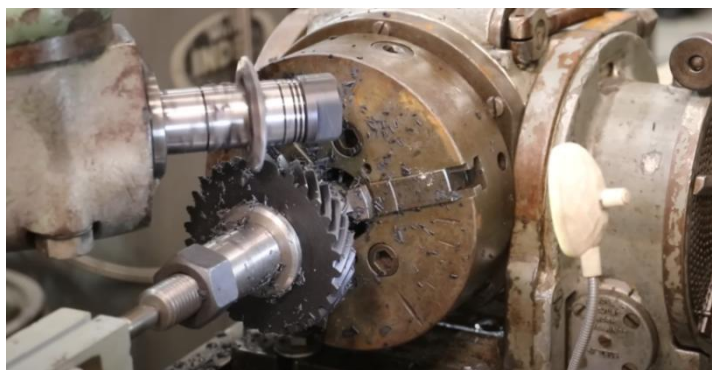
Obr. 3.2 Výroba šikmého ozubení pomocí kontinuálně poháněného univerzálního dělicího přístroje.
