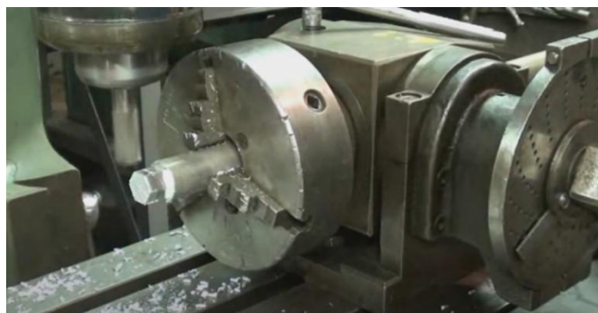
Obr. 2.4 Výroba vícehranu na univerzální frézce za použití univerzálního dělicího přístroje (vpravo je vidět dělicí deska s rotačními stupnicemi (jsou to soustředné kružnice lícovaných děr)).
