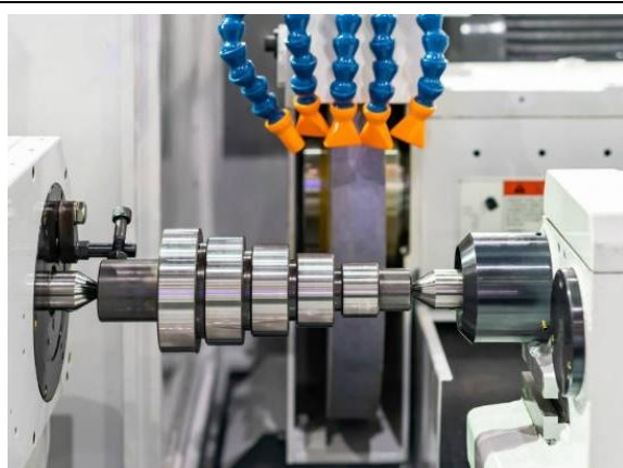
Obr. 2.2 Broušení na kulato.
