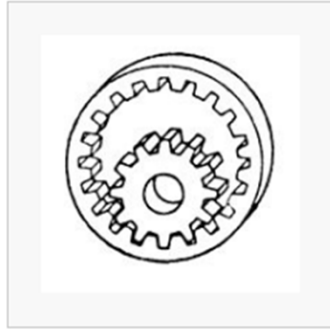
Rovnoběžné osy, vnitřní ozubení, přímé
