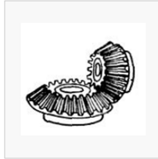
Různoběžné osy, vnější ozubení, přímé
