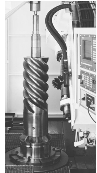
Odvalovací frézování válcového šneku
