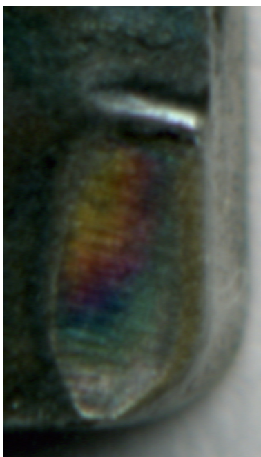
Opořebení na čele VBD:
