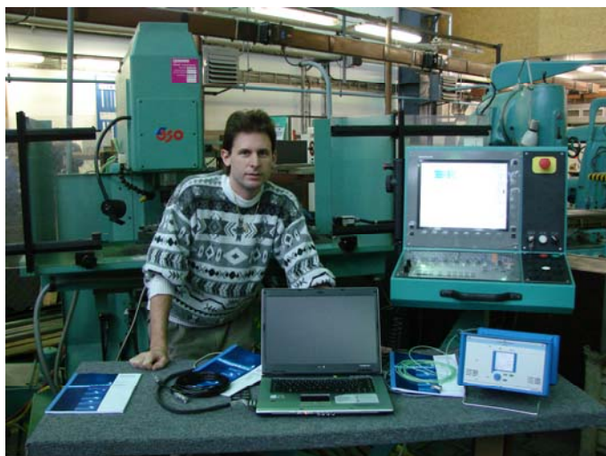
Obr. 2 Propojení aparatury Kistler s konzolovou frézku FV 25 CNC A
