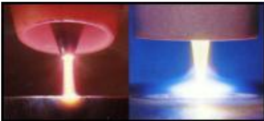
Obr. 2.4 Plazmový paprsek – vlevo, elektrický oblouk WIG - vpravo
