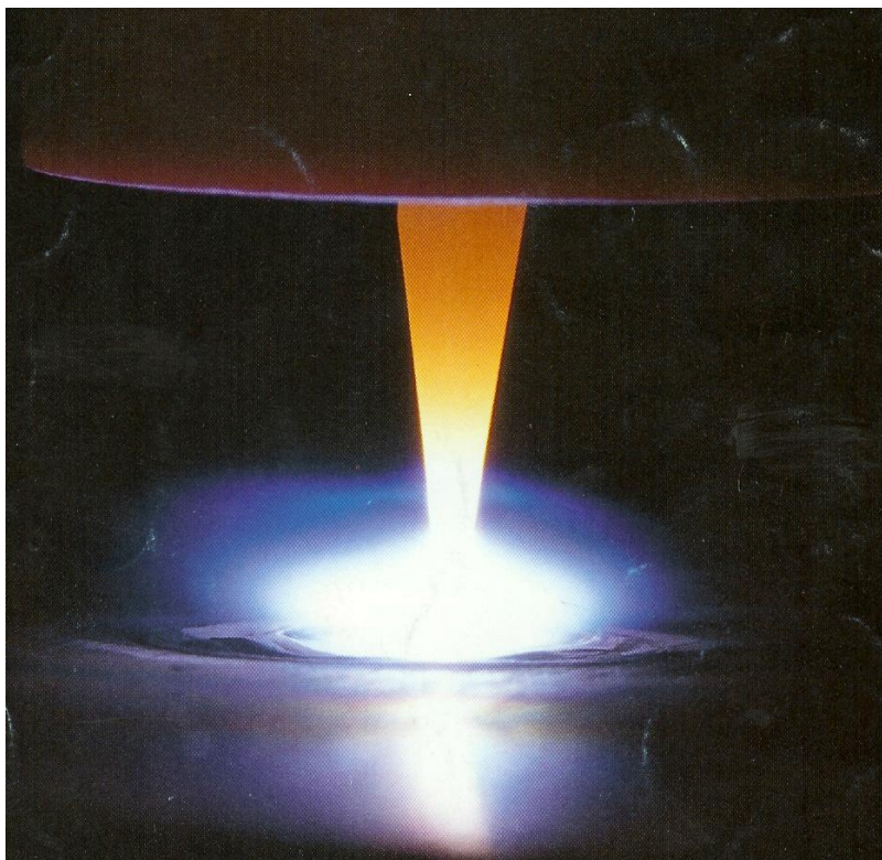
Obr.3.1 Části elektrického oblouku a oblouk při stejnosměrném proudu u WIG.
