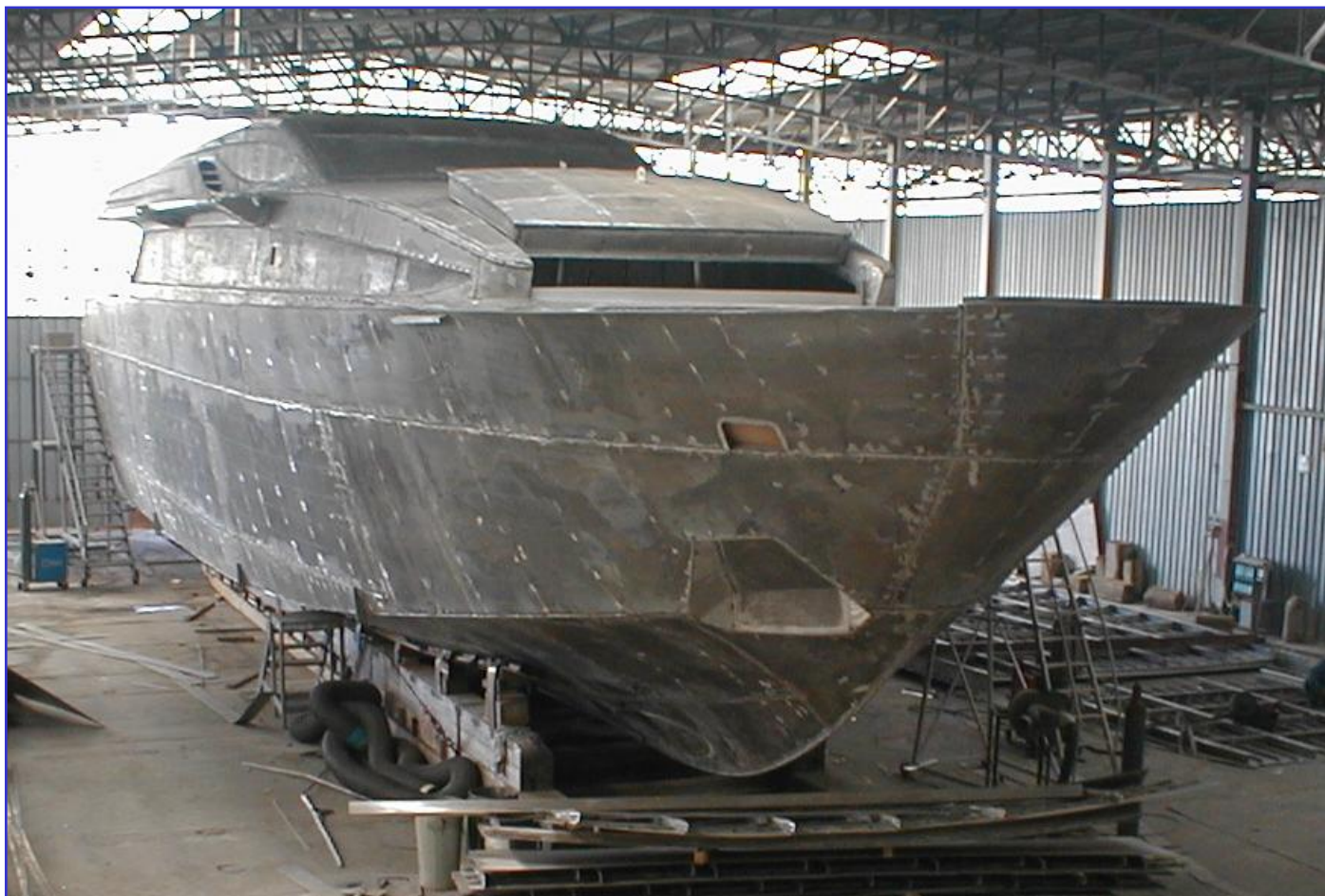
Obr. 8.21 Svařovaný trup celohliníkové jachty
