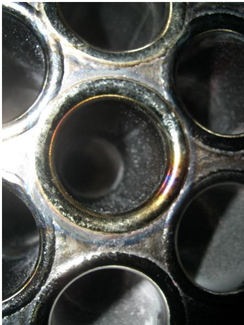
Přivařování trubek do trubkovnice
