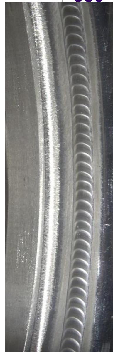
Svar zhotovený v pulzním režimu
