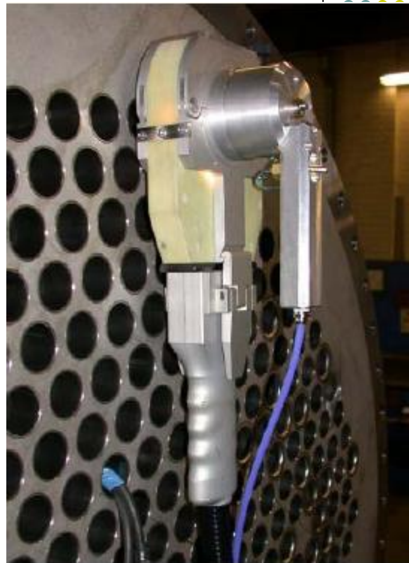
Přivařování trubek do trubkovnice
