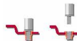
Kontrola krouticího momentu Vyšroubování kontrolovaným kroutícím momentem (lehký chod závitu)
