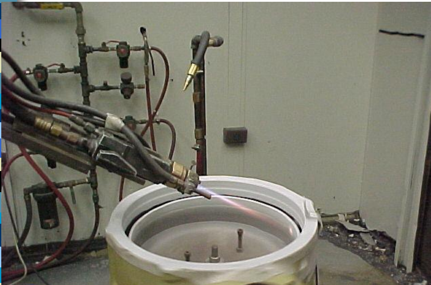
HVOF Hliník a křemík aplikovaný na interiér převodové skříně
