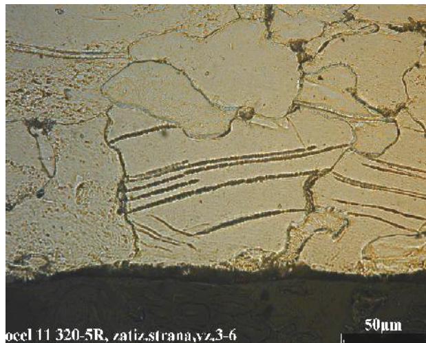
Ohyb deformačních dvojčat v okolí čela vzorku 3-6 při rychlosti dopadu 110,2 m/s.
