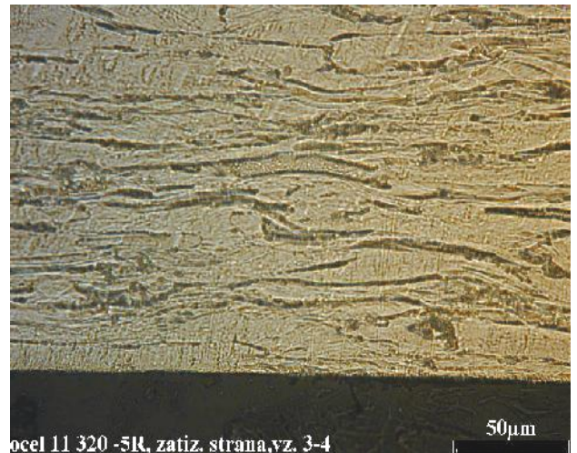
Plastická deformace se smykovými pásy povrchové vrstvy při rychlosti dopadu 231,8 m/s.
