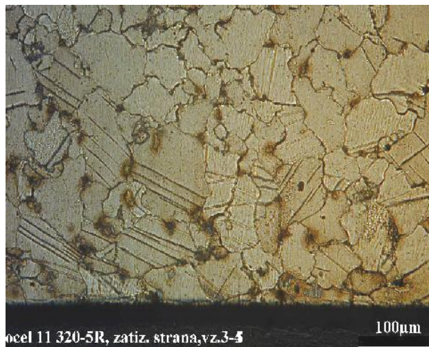
Deformační dvojčata v okolí čela vzorku 3-5 při rychlosti dopadu 63,6 m/s
