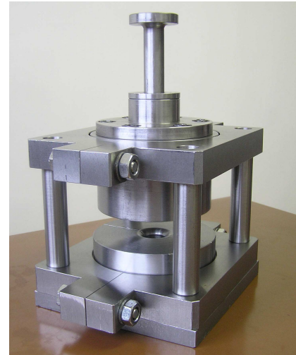
Obr.2 Zkušební nástroj pro vyboulování tenkostěnné trubky do volného prostoru
