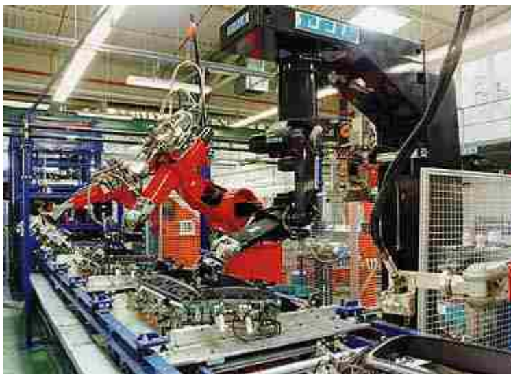
Obr.4 Roboty na lince pro opracování a montáž
