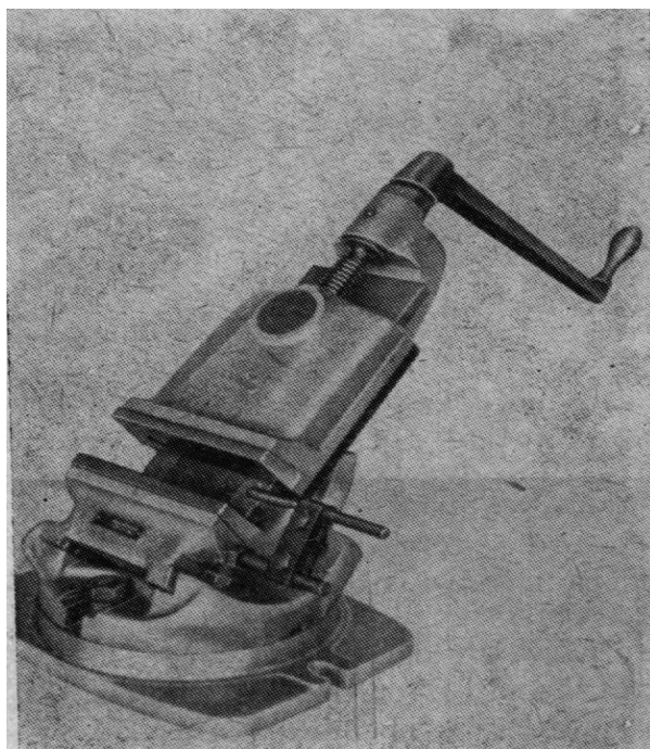
Obrázek 75. a) Strojní sklopný a otočný šroubový svěrák, b) strojní svěrák pákový s výstředníkem a točnicí, c) strojní šroubový svěrák s pneumatickým ovládáním upínání.
