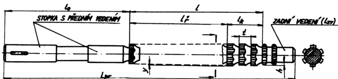
Obrázek 56. Schéma kruhového soustředného protahovacího trnu l_0 – délka stopky s vedením, l_{pr} – celková délka protahovacího trnu, l_{ř} – délka řezné části, l_K – délka kalibrovací části, l – celková délka řezné části, t – rozteč zubů, y – tloušťka třísky, h – hloubka profilu.
