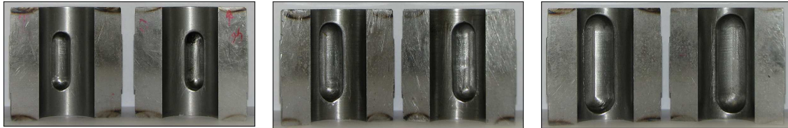
Obr.1 Sada lisovnic šířky 12, 16 a 20 mm o konstantním poměru šířky a délky
