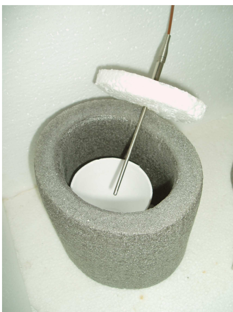
Izolační komůrka pro uložení kelímku s analyzovanou směsí (termočlánek typ T)
