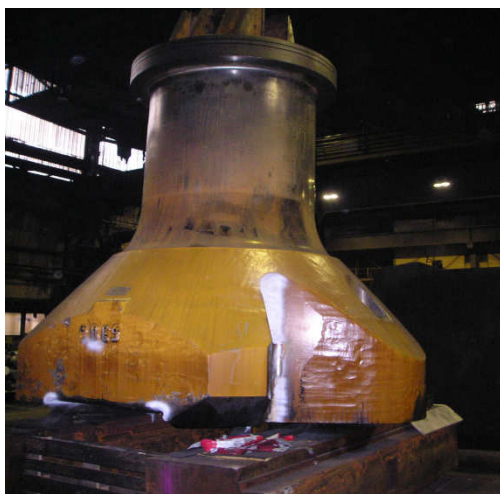
Obr. 2 Foto odlitku horního beranu lisu, hmotnost 85 tun
