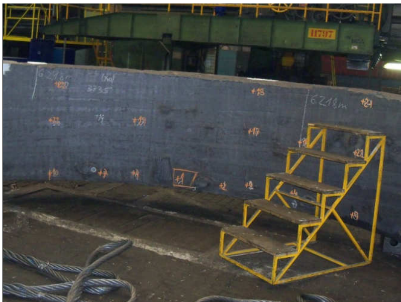
Obr. 2 Foto odlitku nosného kruhu o hmotnosti 130 tun
