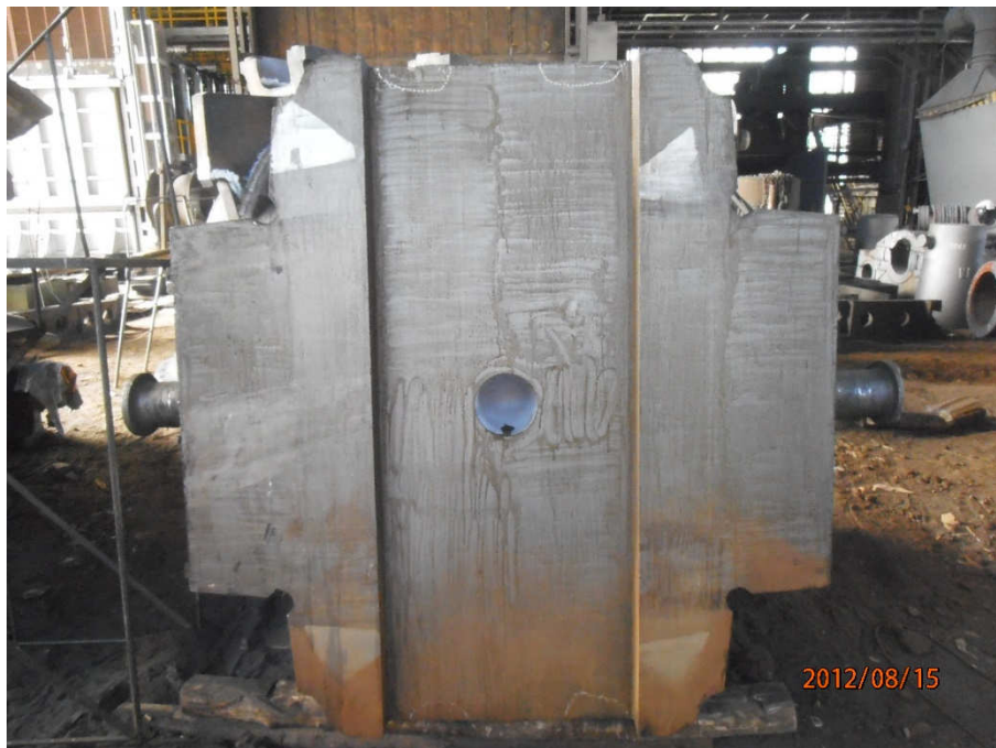
Obr. 2 Foto odlitku horního beranu lisu, hmotnost 45 tun
