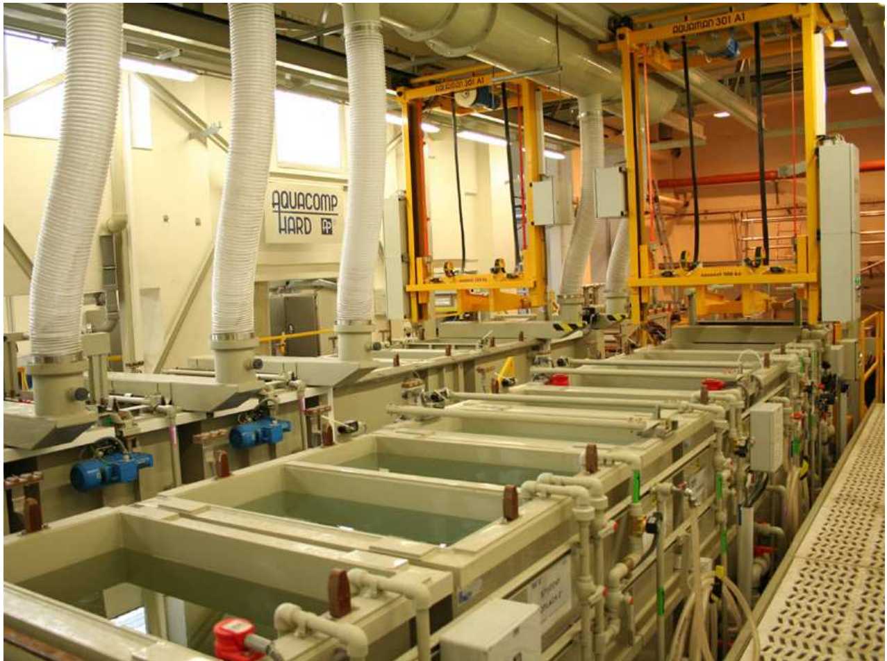
Plně automatická galvanická linka pro stříbření kontaktů elektronických prvků. Kombinovaná linka závěs - bubny. Kombinovaný výkon: 4500 dm 2 /2 směny.
