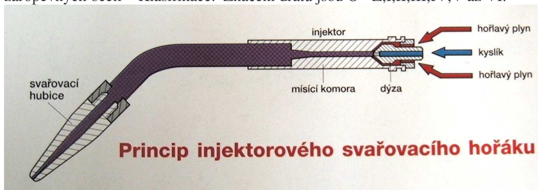
obr.6 Injektorový svařovací hořák
