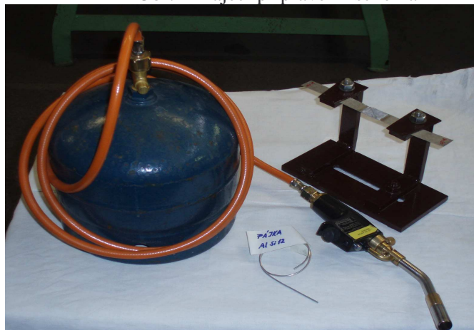
Obr. 2 Ukázka použití přípravku pro pájení
