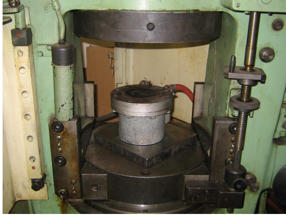
Obr.1 Stroj CZR600 s chladícím zařízením
