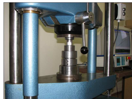
Obr.3 Rozebraný nástroj a umístění na trhacím stroji
