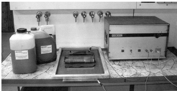
Obr.1 Pracoviště elektrolytického leptání
